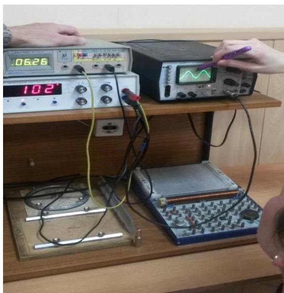
Рис. 3.15. Подготовка установки к изучению электрических колебаний
