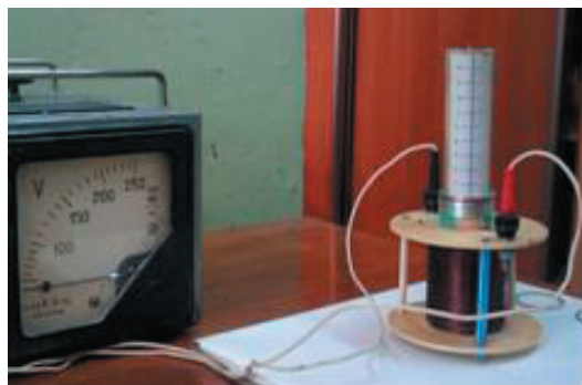
Рис. 3.16. Установка для исследования эффекта «плавающих колец» (трансформатор Э. Томсона)
