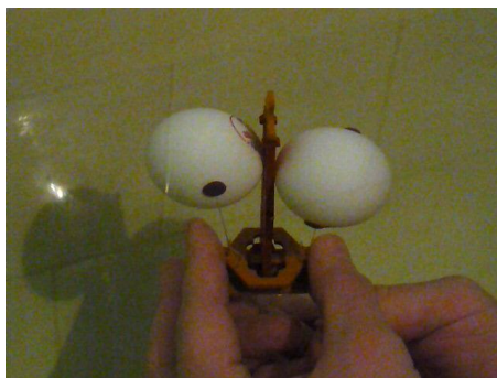
Рис. 3.13. Всплывающий маятник может играть роль «лифта-подъемника» тел на поверхность жидкости
